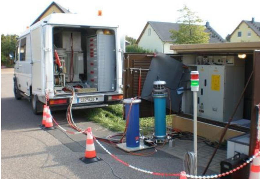
Mobiles Resonanzprüfsystem zur Teilentladungs- und Verlustfaktormessung und Spannungsprüfung
