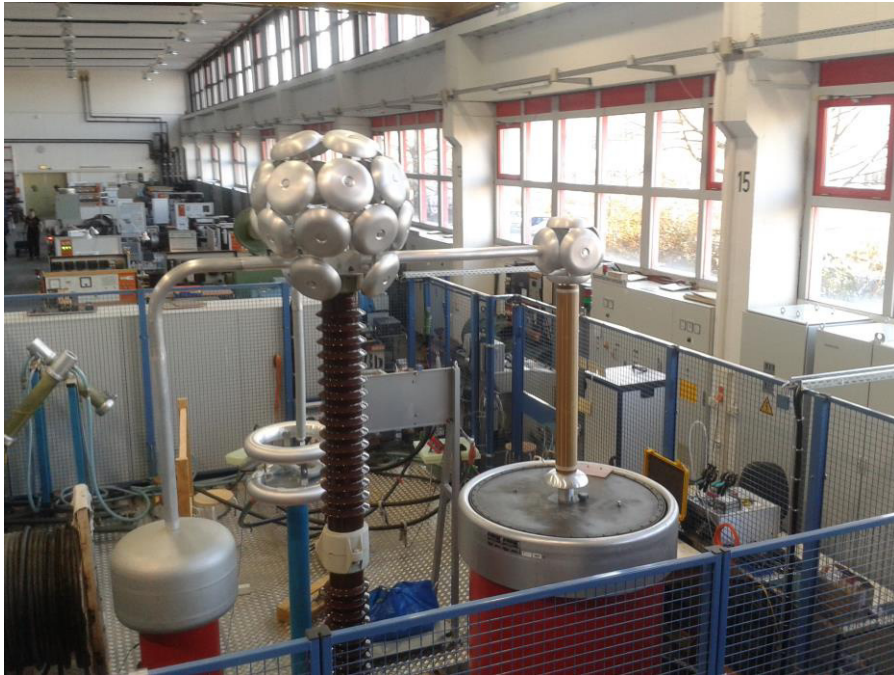
Mobiles Resonanzprüfsystem zur Teilentladungs- und Verlustfaktormessung und Spannungsprüfung
